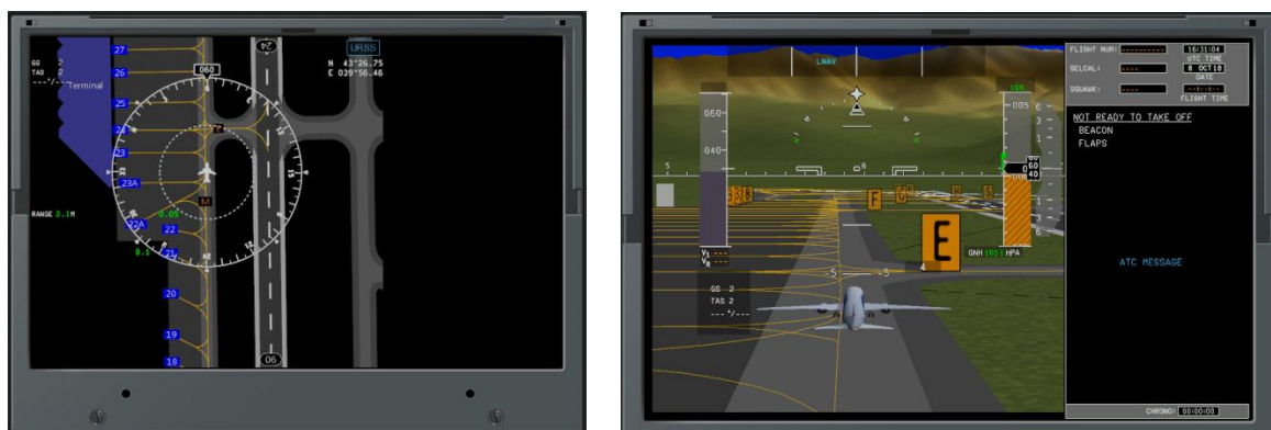
Рисунок 1 – Макет функции АММ в составе кадра ND (слева) и в составе функции синтетического видения PFD стенда прототипирования (справа)
