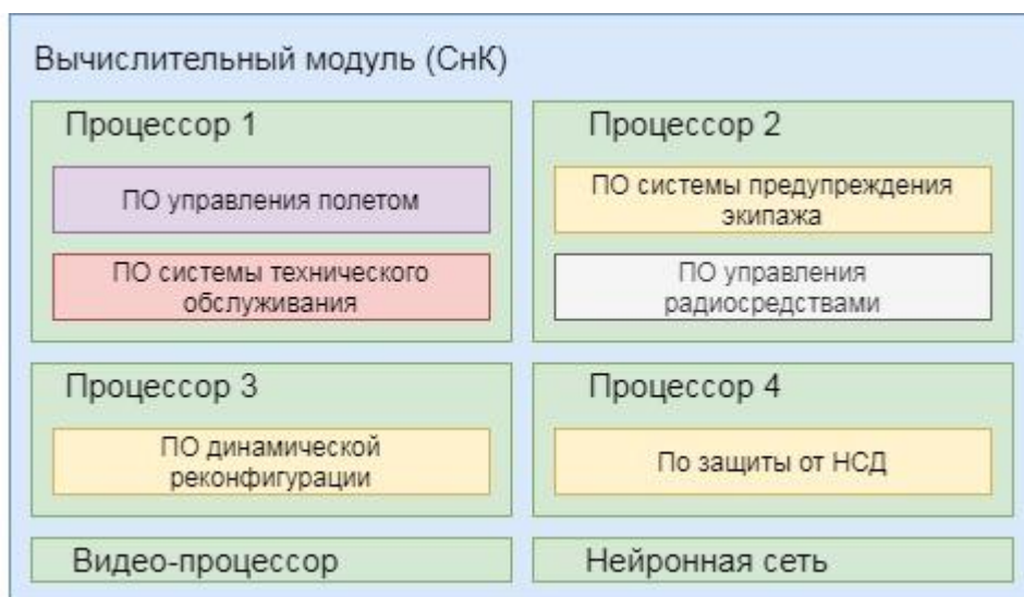
Рисунок 2 – Динамическая реконфигурация в вычислительном модуле, реализованном на базе СнК
