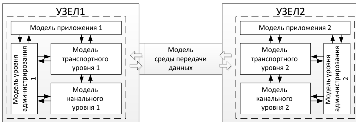
Рисунок 5 – Общая структура программной модели
