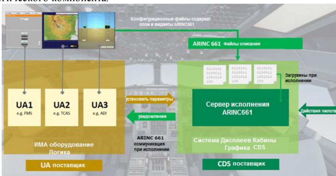
Рисунок 4 – Схема взаимодействия логической и графической частей по технологии ARINC661 (компания ANSYS)
