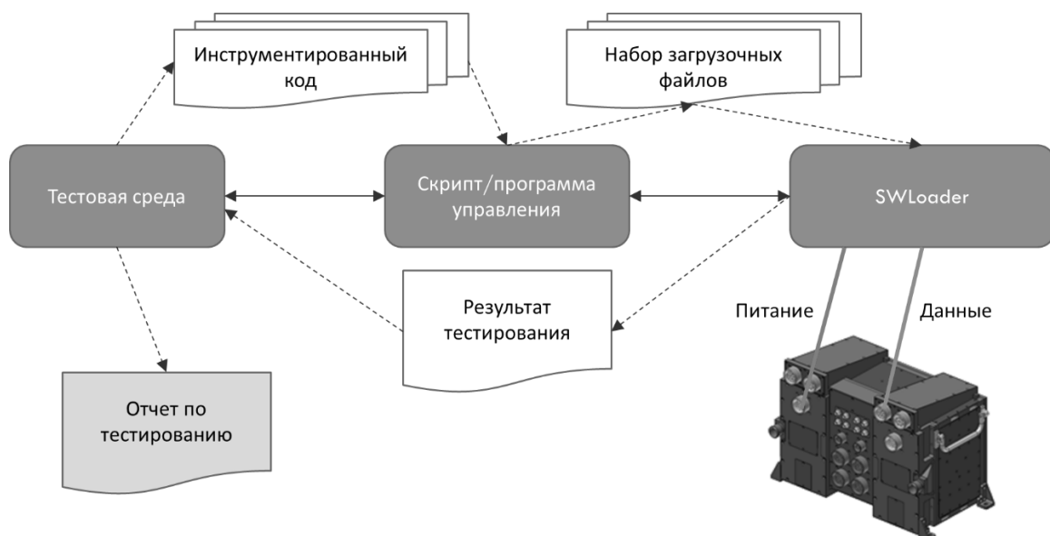
Рисунок 1 – Схема применения загрузчика SWLoader в автоматизированном режиме
