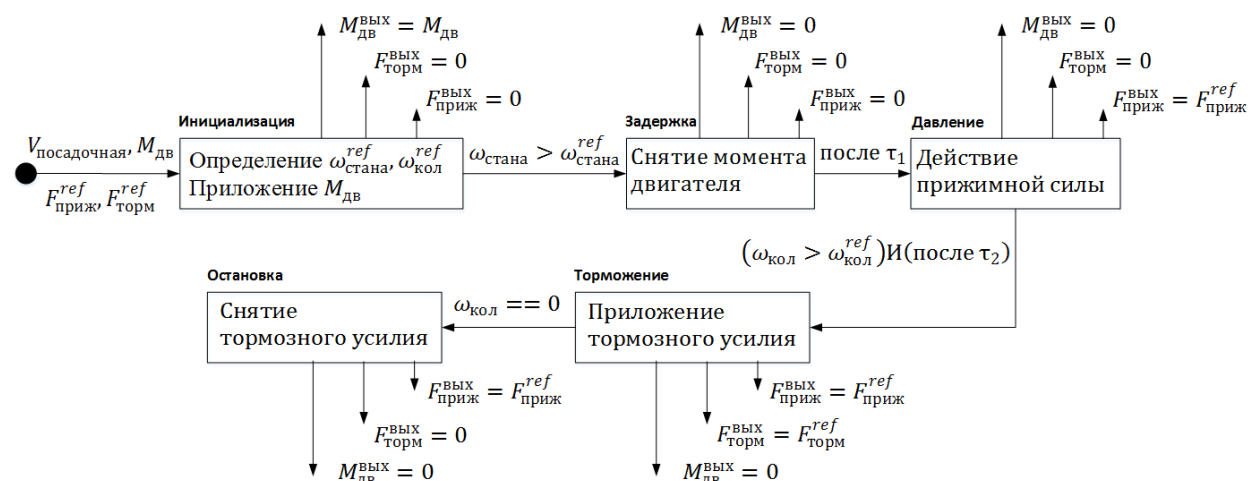
Рисунок 3 – Диаграмма состояний системы управления демонстратора
