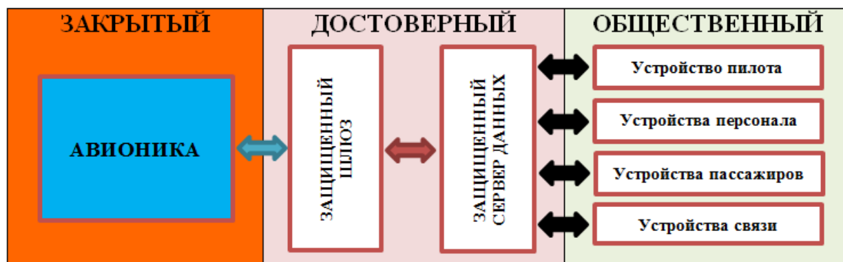
Рисунок 2 – Принцип разделения информационно-вычислительного пространства СПС на контролируемые зоны-домены
