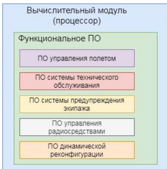
Рисунок 1 – Динамическая реконфигурация в вычислительном модуле, реализованном на базе процессора
