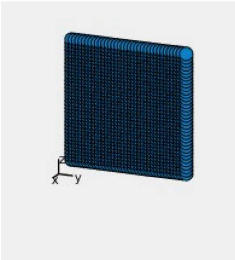
Рисунок 4. Равномерная прямоугольная антенная решётка 36x36 элементов.
