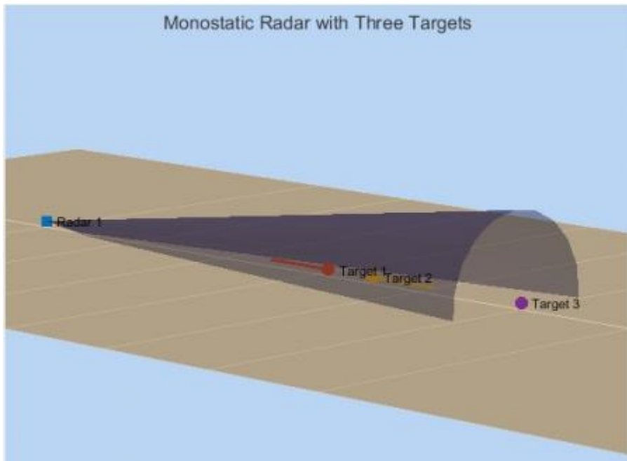
Рисунок 10. Сценарий обнаружения трёх целей с малыми ЭПР радаром X-диапазона.
