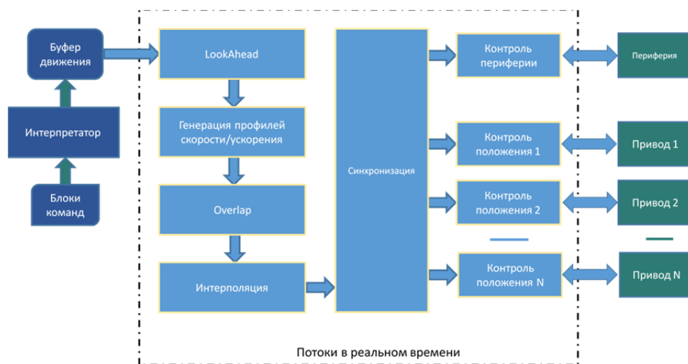
Рис. 2. Блок-схема контроллера движения на базе ОСРВ
