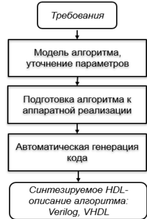
Этапы разработки при модельно-ориентированном проектировании
